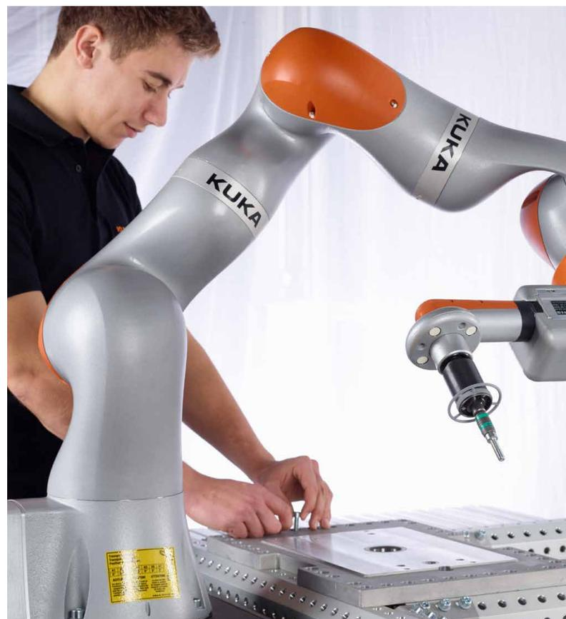
Der sensitive Leichtbauroboter LBR iiwa unterstützt den Menschen in direkter Zusammenarbeit.
