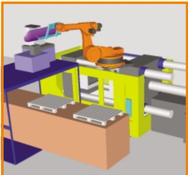
Roboter beim Entladen einer Spritzgussmaschine
