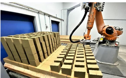
Die Kamera hilft dem Roboter dabei, die exakte Lage der Ofensteine zu erfassen. © Kautenburger GmbH
