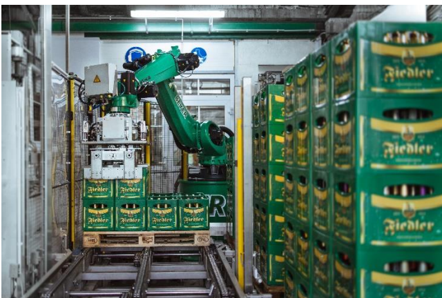
Roboter palettiert Bierkästen: KUKA begegnet dem enormen Automatisierungsbedarf der Konsumgüterindustrie mit passenden Lösungen. © KUKA Group
