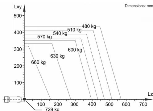
El KR 600 R2830 está diseñado para una carga nominal de 600 kg para aprovechar de forma óptima el rendimiento y la dinámica del robot. Con intervalos de carga reducidos también se pueden aplicar cargas superiores hasta la capacidad de carga máxima. La situación de carga concreta debe controlarse con KUKA.Load. Para un asesoramiento individual, póngase en contacto con KUKA Support.
