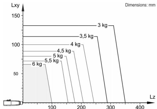
Le KR 6 R900 WP est conçu pour une charge nominale de 3 kg pour une utilisation optimale de la performance et de la dynamique du robot. En réduisant les distances de charges, il est également possible d'utiliser des charges plus élevées jusqu'à la charge maximum. Les cas de charge spécifiques doivent être contrôlés avec KUKA.Load. Notre assistance technique est à votre disposition pour vous conseiller.
