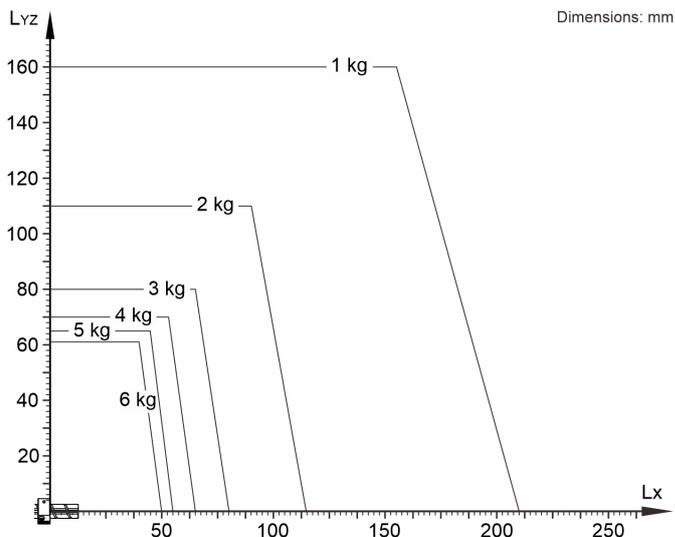
KR 6 R500 Z200 est conçu pour une charge nominale de 3 kg pour une utilisation optimale de la performance et de la dynamique du robot. En réduisant les distances de charges, il est également possible d'utiliser des charges plus élevées jusqu'à la charge maximum. Les cas de charge spécifiques doivent être contrôlés avec KUKA.Load. Notre assistance technique KUKA Support est à votre disposition pour vous conseiller.
