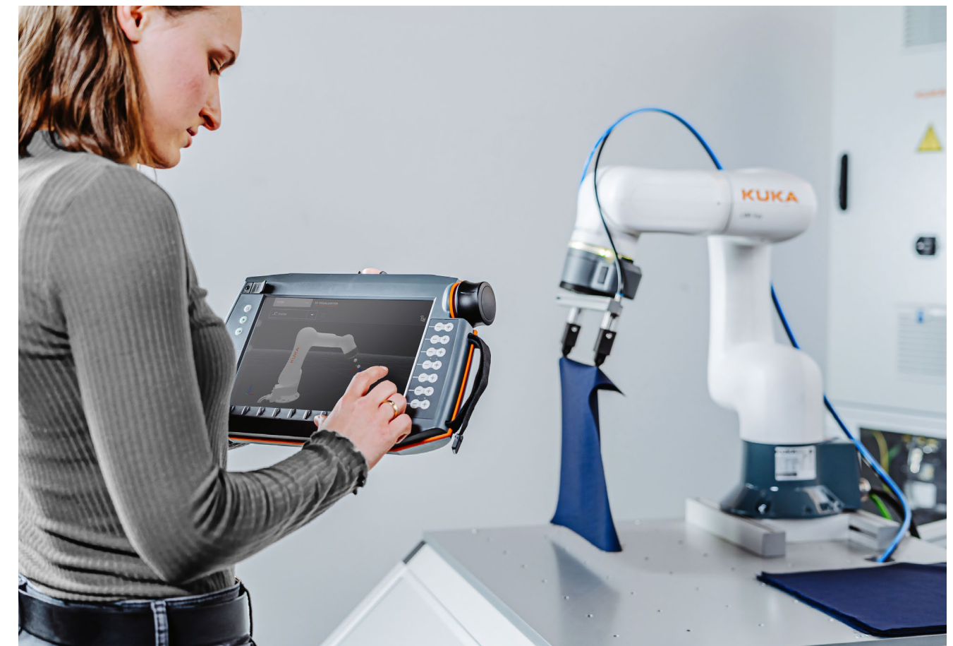
Die Handhabung von biegeschlaffen, also leicht verformbaren, flexiblen Textilien und Schnittteilen ist z. B. mit einem LBR iisy Roboter möglich.
