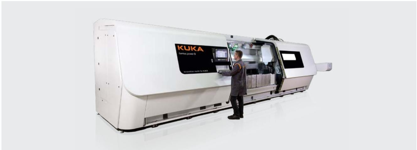
Die neue Doppelkopf-Reibschweißmaschine **KUKA Genius D** nutzt den modularen Baukasten der Genius Produktfamilie und ist die ideale Lösung für Applikationen mit Doppelschweißungen. Verfügbar als **KUKA Genius D power** erlaubt sie höchste Effizienz und simultanes Schweißen des Bauteils an beiden Enden in einem Arbeitszyklus (one-pass-productivity).
