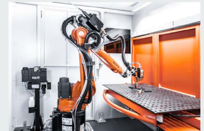
Der KR CYBERTECH nano bei einer Schweißapplikation in unserer Standardzelle KUKA cell4_arc compact.
