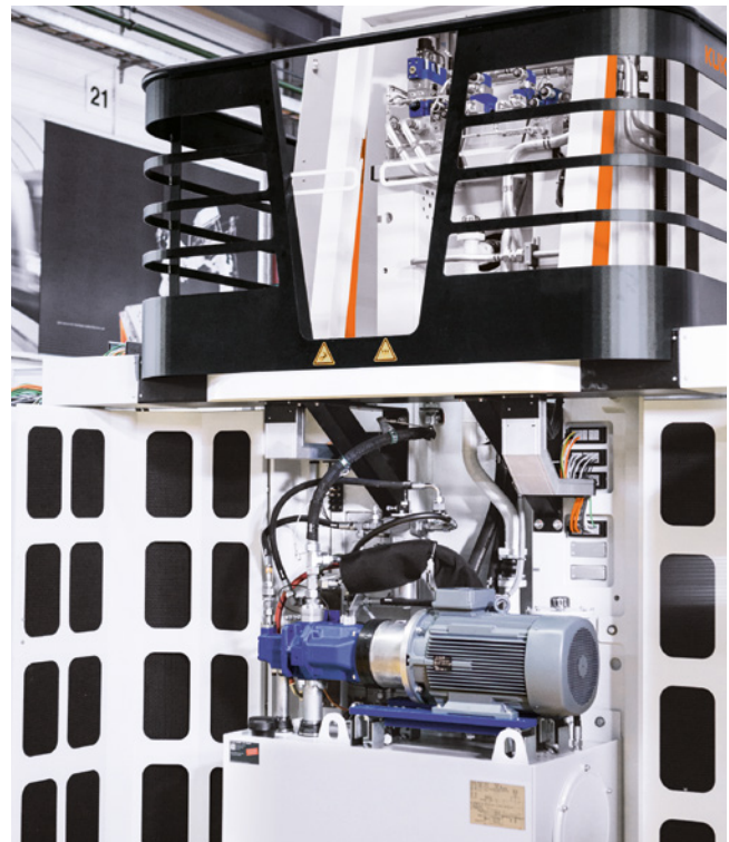
Integrierter Hydraulikschrank mit großzügigen Wartungstüren
