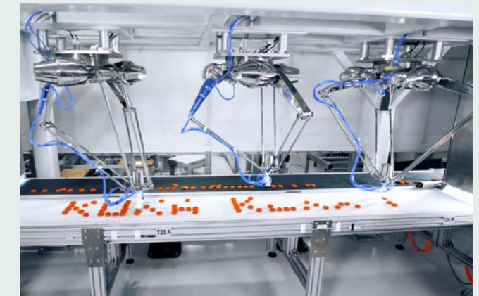
Mit flexiblen DELTA Robotern und passender Hard- und Software bietet KUKA kostengünstige Lösungen für das automatisierte Kommissionieren und Verpacken.
