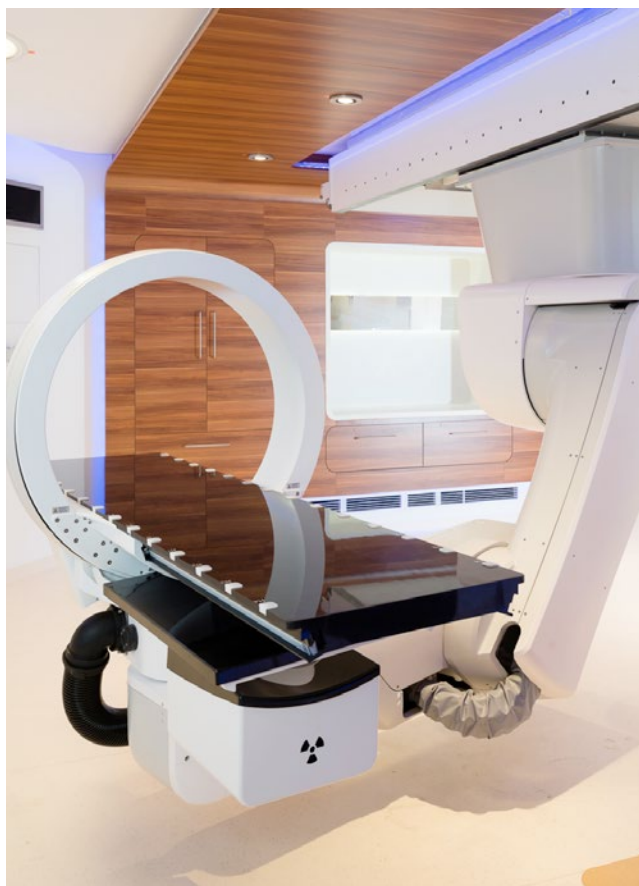
用 KUKA 机器人可以在基于粒子的放射治疗中精确定位患者。 (© Thomas Kästenbauer)
