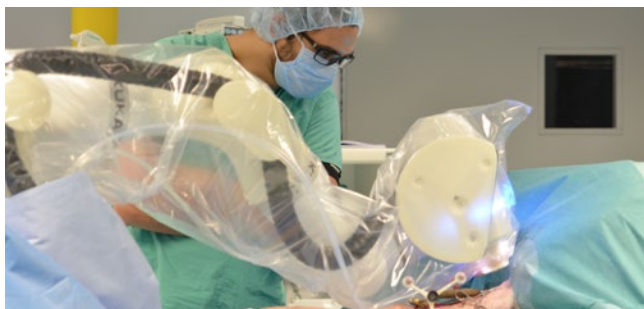
配有激光头的 KUKA 轻型机器人可以以前所未有的精度进行骨科手术 (© AOT)
