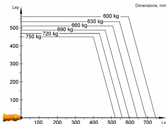
Il KR 1000 L750 titan è progettato per una portata nominale di 750 kg in grado di sfruttare al meglio le prestazioni e la dinamicità del robot. Con distanze di carico ridotte e carichi addizionali favorevoli è possibile applicare un carico utile massimo di 750 kg. La situazione di carico specifica deve essere verificata con KUKA Load. Per un'ulteriore consulenza il servizio di assistenza KUKA rimane a vostra disposizione.
