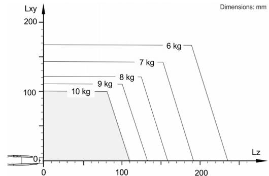
El KR 10 R1420 está diseñado para una carga nominal de 10 kg para aprovechar de forma óptima el rendimiento y la dinámica del robot. Con intervalos de carga reducidos también se pueden aplicar cargas superiores hasta la capacidad de carga máxima. La situación de carga concreta debe controlarse con KUKA.Load. Para un asesoramiento individual, póngase en contacto con KUKA Support.
