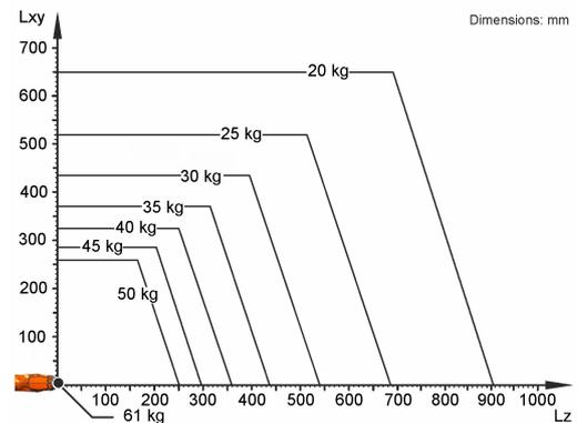
Il KR 50 R2100 è progettato per una portata nominale di 50 kg in grado di sfruttare al meglio le prestazioni e la dinamicità del robot. Con distanze di carico ridotte e carichi addizionali favorevoli è possibile applicare un carico utile massimo di 61 kg. La situazione di carico specifica deve essere verificata con KUKA Load. Per un'ulteriore consulenza il servizio di assistenza KUKA rimane a vostra disposizione.
