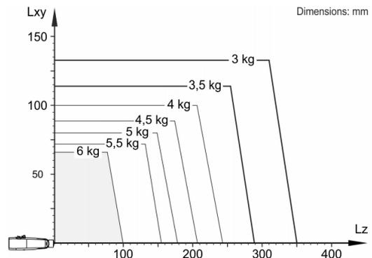
KR 6 R900 EX está configurado para una carga nominal de 3 kg para aprovechar de forma óptima el rendimiento y la dinámica del robot. Solo si la posición del centro de gravedad de la masa es de 0 mm y se ha aplicado una carga adicional optimizada para la situación de carga, se aplica la carga máxima de 6 kg. La situación de carga específica debe comprobarse con KUKA.Load o KUKA Compose. Para un asesoramiento individual, póngase en contacto con KUKA Support.
