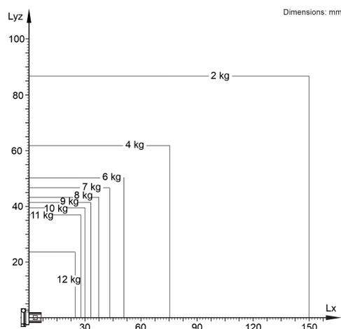
O KR 12 R750 Z400 está configurado para uma capacidade de carga nominal de 6 kg, para usar de forma ideal o desempenho e a dinâmica do manipulador. Com distâncias de carga reduzidas podem ser aplicadas também cargas maiores até a capacidade de carga máxima. O caso de carga específico deve ser verificado com KUKA.Load. O Suporte KUKA está à sua disposição para maiores detalhes.
