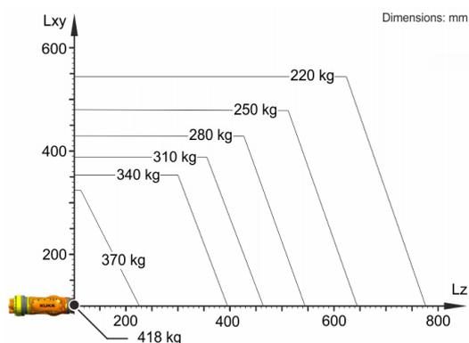
Il KR 340 R3330 F è progettato per una portata nominale di 340 kg in grado di sfruttare al meglio le prestazioni e la dinamicità del robot. Il carico utile massimo di 418 kg vale solo quando sono applicati una posizione del baricentro di 0 mm e un carico aggiuntivo ottimizzato per la situazione di carico. La situazione di carico specifica deve essere verificata con KUKA.Load o KUKA Compose. Per un'ulteriore consulenza il servizio di assistenza KUKA rimane a vostra disposizione.
