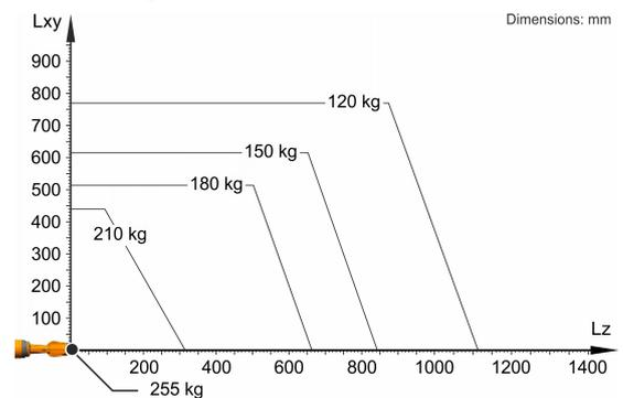
KR 210 R3100-2 C está configurado para una carga nominal de 210 kg para aprovechar de forma óptima el rendimiento y la dinámica del robot. Solo si la posición del centro de gravedad de la masa es de 0 mm y se ha aplicado una carga adicional optimizada para la situación de carga, se aplica la carga máxima de 255 kg. La situación de carga específica debe comprobarse con KUKA.Load o KUKA Compose. Para un asesoramiento individual, póngase en contacto con KUKA Support.
