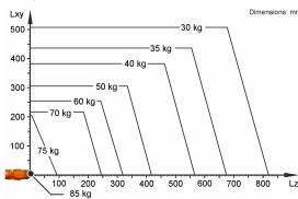
Der KR 70 R2100 HO ist ausgelegt für eine Nenn-Traglast von 70 kg, um die Performance und Dynamik des Roboters optimal zu nutzen. Mit reduzierten Lastabständen und günstigen Zusatzlasten, kann eine maximale Traglast bis zu 85 kg angebracht werden. Der spezifische Lastfall muss mit KUKA Load überprüft werden. Für weitere Beratung steht der KUKA Service zur Verfügung.
