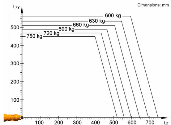
Der KR 1000 L750 titan ist ausgelegt für eine Nenn-Traglast von 750 kg, um die Performance und Dynamik des Roboters optimal zu nutzen. Mit reduzierten Lastabständen und günstigen Zusatzlasten, kann eine maximale Traglast bis zu 750 kg angebracht werden. Der spezifische Lastfall muss mit KUKA Load überprüft werden. Für weitere Beratung steht der KUKA Service zur Verfügung.
