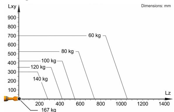
Der KR 120 R2700-2 F ist ausgelegt für eine Nenn-Traglast von 120 kg, um die Performance und Dynamik des Roboters optimal zu nutzen. Nur wenn die Lage des Massenschwerpunkts 0 mm und eine für den Lastfall optimierte Zusatzlast angebracht sind, gilt die maximale Traglast von 167 kg. Der spezifische Lastfall muss mit KUKA.Load oder KUKA Compose überprüft werden. Für weitere Beratung steht der KUKA Support zur Verfügung.
