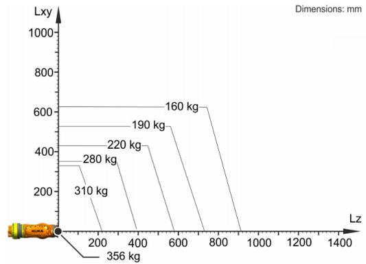
KR 280 R3080 está configurado para una carga nominal de 280 kg para aprovechar de forma óptima el rendimiento y la dinámica del robot. Solo si la posición del centro de gravedad de la masa es de 0 mm y se ha aplicado una carga adicional optimizada para la situación de carga, se aplica la carga máxima de 356 kg. La situación de carga específica debe comprobarse con KUKA.Load o KUKA Compose. Para un asesoramiento individual, póngase en contacto con KUKA Support.
