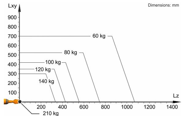
KR 120 R3100-2 F está configurado para una carga nominal de 120 kg para aprovechar de forma óptima el rendimiento y la dinámica del robot. Solo si la posición del centro de gravedad de la masa es de 0 mm y se ha aplicado una carga adicional optimizada para la situación de carga, se aplica la carga máxima de 210 kg. La situación de carga específica debe comprobarse con KUKA.Load o KUKA Compose. Para un asesoramiento individual, póngase en contacto con KUKA Support.
