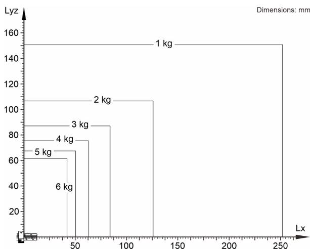
Le KR 6 R500 Z200 est conçu pour une charge nominale de 3 kg pour une utilisation optimale de la performance et de la dynamique du manipulateur. En réduisant les distances de charges, il est également possible d'utiliser des charges plus élevées jusqu'à la charge maximum. Les cas de charge spécifiques doivent être contrôlés avec KUKA.Load. Notre assistance technique KUKA Support est à votre disposition pour vous conseiller.
