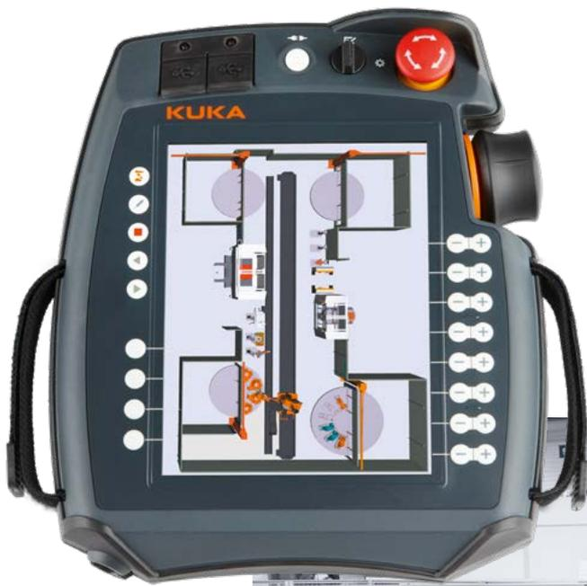
**Voller Überblick.** Die physikalische Welt der Bearbeitungszelle mit zwei Bearbeitungszentren, einem KUKA Roboter auf Line-arachse und vier Zuführstationen wird auf dem Bildschirm des KUKA smartPAD visualisiert und erlaubt den vollen Überblick darüber, was in der Zelle passiert.
