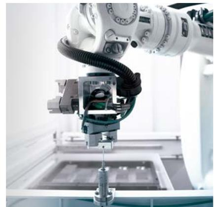
**Messen.** Integrierte Messstationen in der Automatisierungszelle geben zeitnahe Rückmeldung über die Qualität der Bearbeitung.
