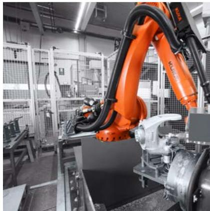
**Präzision in der Nachbearbeitung.** Einmal eingerichtet, erledigt der Roboter Aufgaben wie Bohren oder Entgraten zuverlässig und in höchster Qualität – und quasi unterbrechungsfrei bei einer MTBF von 40.000 Stunden.
