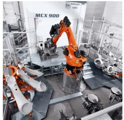
**Zuverlässig auch bei hohem Gewicht.** Auch schwere Bauteile werden präzise und ohne Risiko von Beschädigungen an Maschine oder Spannmittel eingelegt. Das Beladen erfolgt positionsgenau. Ausschuss durch falsche Platzierung ist ausgeschlossen.
