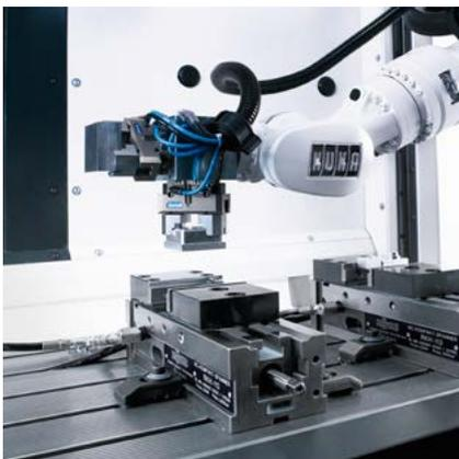
**Werkstück Be- und Entladung.** An dieser DMG Mori Maschine mit zwei Aufspannungen werden die Werkstücke gleich von sechs Seiten bearbeitet. Der Roboter be- und entlädt und bringt dabei jedes Werkstück in die optimale Bearbeitungsposition.
