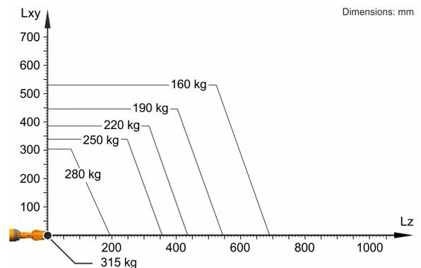
Der KR 250 R2700-2 F ist ausgelegt für eine Nenn-Traglast von 250 kg, um die Performance und Dynamik des Roboters optimal zu nutzen. Nur wenn die Lage des Massenschwerpunkts 0 mm und eine für den Lastfall optimierte Zusatzlast angebracht sind, gilt die maximale Traglast von 315 kg. Der spezifische Lastfall muss mit KUKA.Load oder KUKA Compose überprüft werden. Für weitere Beratung steht der KUKA Support zur Verfügung.
