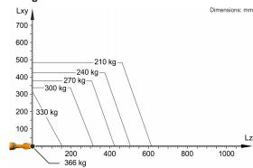
Der KR 300 R2700-2 C ist ausgelegt für eine Nenn-Traglast von 300 kg, um die Performance und Dynamik des Roboters optimal zu nutzen. Nur wenn die Lage des Massenschwerpunkts 0 mm und eine für den Lastfall optimierte Zusatzlast angebracht sind, gilt die maximale Traglast von 366 kg. Der spezifische Lastfall muss mit KUKA.Load oder KUKA Compose überprüft werden. Für weitere Beratung steht der KUKA Support zur Verfügung.
