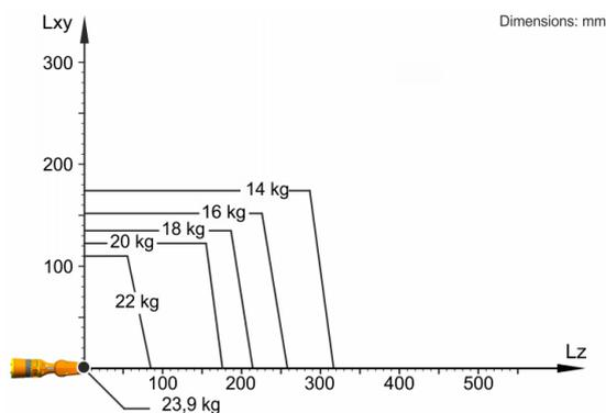
Il KR 20 R1810 F è progettato per una portata nominale di 20 kg in grado di sfruttare al meglio le prestazioni e la dinamicità del robot. Il carico utile massimo di 23,9 kg vale solo quando sono applicati una posizione del baricentro di 0 mm e un carico aggiuntivo ottimizzato per la situazione di carico. La situazione di carico specifica deve essere verificata con KUKA.Load o KUKA Compose. Per un'ulteriore consulenza il servizio di assistenza KUKA rimane a vostra disposizione.
