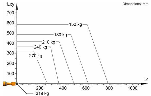
KR 240 R2900-2 F 设计用于 240 kg 的额定负载能力，以便最佳利用机器人的性能和动态性。仅在质量重心位置为 0 mm 且安装了针对负载规格优化过的附加负载时，319 kg 的最大负载能力才适用。必须用 KUKA.Load 或 KUKA Compose 检查特殊的负载情况。如果需要详细咨询，请联系 KUKA 支持部。
