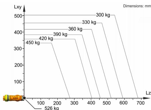
O KR 420 R3080 F está configurado para uma capacidade de carga nominal de 420 kg, para usar de forma ideal o desempenho e a dinâmica do robô. Somente se a posição do centro de gravidade da massa for 0 mm e estiver colocada uma carga adicional otimizada para o caso de carga, é válida a capacidade de carga máxima de 526 kg. O caso de carga específico deve ser controlado com KUKA.Load ou KUKA Compose. O Suporte KUKA está à sua disposição para maiores detalhes.
