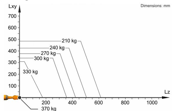
Der KR 300 R2700-2 F ist ausgelegt für eine Nenn-Traglast von 300 kg, um die Performance und Dynamik des Roboters optimal zu nutzen. Nur wenn die Lage des Massenschwerpunkts 0 mm und eine für den Lastfall optimierte Zusatzlast angebracht sind, gilt die maximale Traglast von 370 kg. Der spezifische Lastfall muss mit KUKA.Load oder KUKA Compose überprüft werden. Für weitere Beratung steht der KUKA Support zur Verfügung.
