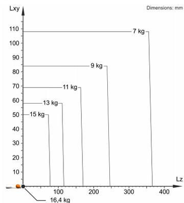
LBR iisy 15 R930 está configurado para una carga nominal de 15 kg para aprovechar de forma óptima el rendimiento y la dinámica del robot. Solo si la posición del centro de gravedad de la masa es de 0 mm, se aplica la carga máxima de 16,41 kg. La situación de carga específica debe comprobarse con KUKA.Load o KUKA Compose. Para un asesoramiento individual, póngase en contacto con KUKA Support.
