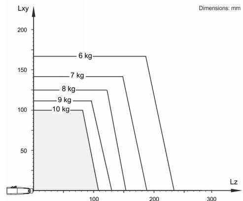
Der KR 10 R1100 EX ist ausgelegt für eine Nenn-Traglast von 5 kg, um die Performance und Dynamik des Roboters optimal zu nutzen. Nur wenn die Lage des Massenschwerpunkts 0 mm und eine für den Lastfall optimierte Zusatzlast angebracht sind, gilt die maximale Traglast von 10 kg. Der spezifische Lastfall muss mit KUKA.Load oder KUKA Compose überprüft werden. Für weitere Beratung steht der KUKA Support zur Verfügung.
