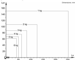
KR 6 R500 Z200 está configurado para una carga nominal de 3 kg para aprovechar de forma óptima el rendimiento y la dinámica del manipulador. Con intervalos de carga reducidos también se pueden aplicar cargas superiores hasta la capacidad de carga máxima. La situación de carga concreta debe controlarse con KUKA.Load. Para un asesoramiento individual, póngase en contacto con KUKA Support.
