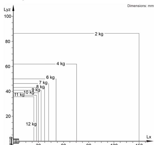
Il KR 12 R650 Z400 è progettato per una portata nominale di 6 kg in grado di sfruttare al meglio le prestazioni e la dinamicità del manipolatore. Con distanze di carico ridotte possono essere utilizzati anche carichi maggiori fino al carico portante massimo. La situazione di carico specifica deve essere verificata con KUKA.Load. Per un'ulteriore consulenza il servizio di assistenza KUKA rimane a vostra disposizione.
