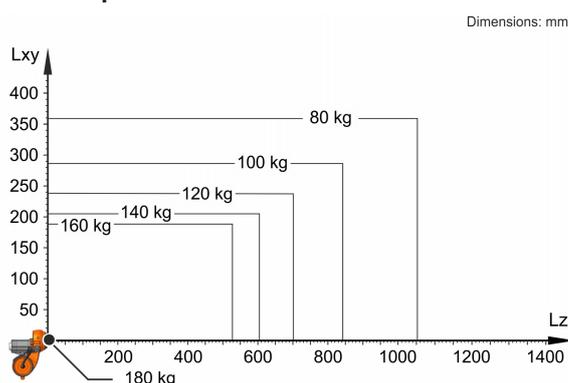
Il KR 140 R3200-2 PA è progettato per una portata nominale di 140 kg in grado di sfruttare al meglio le prestazioni e la dinamicità del robot. Con distanze di carico ridotte e carichi addizionali favorevoli è possibile applicare un carico utile massimo di 180 kg. La situazione di carico specifica deve essere verificata con KUKA Load. Per un'ulteriore consulenza il servizio di assistenza KUKA rimane a vostra disposizione.
