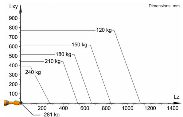
KR 210 R3100-2 F está configurado para una carga nominal de 210 kg para aprovechar de forma óptima el rendimiento y la dinámica del robot. Solo si la posición del centro de gravedad de la masa es de 0 mm y se ha aplicado una carga adicional optimizada para la situación de carga, se aplica la carga máxima de 281 kg. La situación de carga específica debe comprobarse con KUKA.Load o KUKA Compose. Para un asesoramiento individual, póngase en contacto con KUKA Support.
