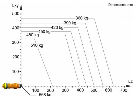
O KR 480 R3330 MT-F está configurado para uma capacidade de carga nominal de 480 kg, para usar de forma ideal o desempenho e a dinâmica do robô. Somente se a posição do centro de gravidade da massa for 0 mm e estiver colocada uma carga adicional otimizada para o caso de carga, é válida a capacidade de carga máxima de 568 kg. O caso de carga específico deve ser controlado com KUKA.Load ou KUKA Compose. O Suporte KUKA está à sua disposição para maiores detalhes.
