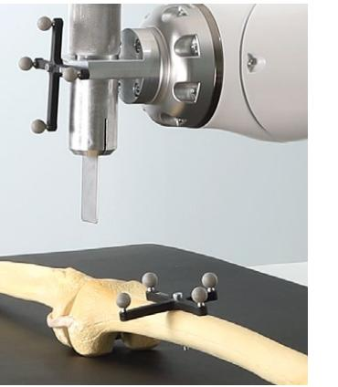
**Orthopädische Chirurgie:** Dank seiner stabilen Ausführung und Konstruktion sowie seiner hohen Steifigkeit eignet sich der LBR Med besonders gut für die Knochenchirurgie. Open-Source-Bibliotheken erleichtern die schnelle Entwicklung von Prototypen sowie die Integration von Navigationskameras.
