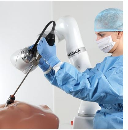
**Minimalinvasive Chirurgie:** Die hoch entwickelte Steuerung ermöglicht präzises Agieren unter Berücksichtigung einer Trokarkinematik. Der Benutzer kann frei wählen, ob er die Applikation automatisiert, interaktiv oder telemanipuliert betreibt.
