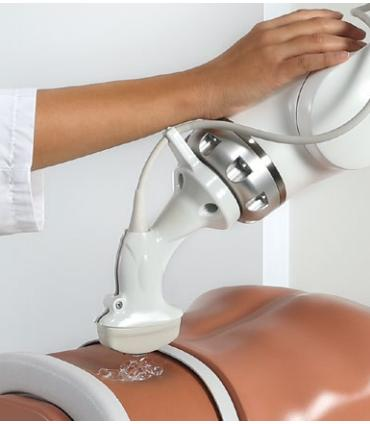
**Ultraschalldiagnostik:** Sensitive Technologie und sichere Mensch-Roboter-Kollaboration sind die Domäne des LBR Med. Dank der integrierten Sensorik kann er sowohl interaktiv mit dem Arzt als auch telemanipuliert auf seine Umgebung reagieren.
