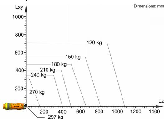
Il KR 240 R3330 è progettato per una portata nominale di 240 kg in grado di sfruttare al meglio le prestazioni e la dinamicità del robot. Il carico utile massimo di 297 kg vale solo quando sono applicati una posizione del baricentro di 0 mm e un carico aggiuntivo ottimizzato per la situazione di carico. La situazione di carico specifica deve essere verificata con KUKA.Load o KUKA Compose. Per un'ulteriore consulenza il servizio di assistenza KUKA rimane a vostra disposizione.
