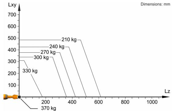
KR 300 R2700-2 está configurado para una carga nominal de 300 kg para aprovechar de forma óptima el rendimiento y la dinámica del robot. Solo si la posición del centro de gravedad de la masa es de 0 mm y se ha aplicado una carga adicional optimizada para la situación de carga, se aplica la carga máxima de 370 kg. La situación de carga específica debe comprobarse con KUKA.Load o KUKA Compose. Para un asesoramiento individual, póngase en contacto con KUKA Support.
