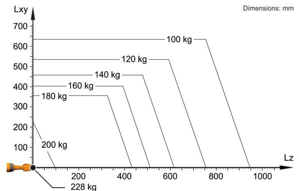
KR 180 R3500-2 K está configurado para una carga nominal de 180 kg para aprovechar de forma óptima el rendimiento y la dinámica del robot. Solo si la posición del centro de gravedad de la masa es de 0 mm y se ha aplicado una carga adicional optimizada para la situación de carga, se aplica la carga máxima de 228 kg. La situación de carga específica debe comprobarse con KUKA.Load o KUKA Composite. Para un asesoramiento individual, póngase en contacto con KUKA Support.
