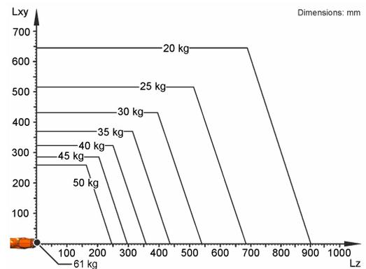
O KR 50 R2500 F está configurado para uma capacidade de carga nominal de 50 kg, para usar de forma ideal o desempenho e a dinâmica do robô. Com distâncias de carga reduzidas e cargas adicionais favoráveis, pode ser instalada uma capacidade de carga máxima de até 61 kg. O caso de carga específico deve ser verificado com KUKA Load. O KUKA Service está à sua disposição para mais consultoria.
