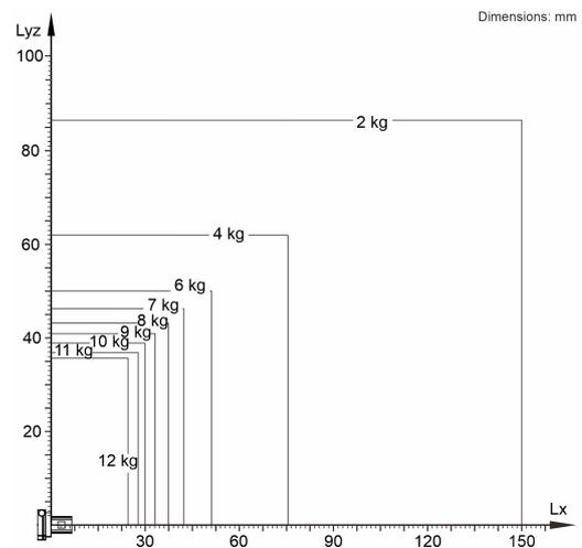
Der KR 12 R650 Z400 ist für eine Nenn-Traglast von 6 kg ausgelegt, um die Performance und Dynamik des Manipulators optimal zu nutzen. Mit reduzierten Lastabständen können auch höhere Lasten bis zur maximalen Traglast zur Anwendung kommen. Der spezifische Lastfall muss mit KUKA.Load überprüft werden. Für weitere Beratung steht der KUKA Support zur Verfügung.
