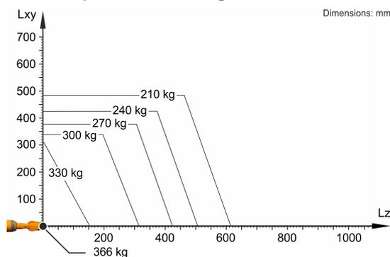
O KR 300 R2700-2 C está configurado para uma capacidade de carga nominal de 300 kg, para usar de forma ideal o desempenho e a dinâmica do robô. Somente se a posição do centro de gravidade da massa for 0 mm e estiver colocada uma carga adicional otimizada para o caso de carga, é válida a capacidade de carga máxima de 366 kg. O caso de carga específico deve ser controlado com KUKA.Load ou KUKA Compose. O Suporte KUKA está à sua disposição para maiores detalhes.
