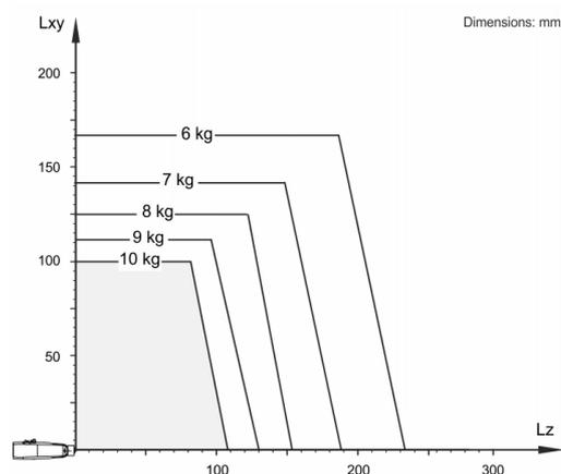
Il KR 10 R900 WP è progettato per una portata nominale di 5 kg in grado di sfruttare al meglio le prestazioni e la dinamicità del robot. Il carico utile massimo di 10 kg vale solo quando sono applicati una posizione del baricentro di 0 mm e un carico aggiuntivo ottimizzato per la situazione di carico. La situazione di carico specifica deve essere verificata con KUKA.Load o KUKA Compose. Per un'ulteriore consulenza il servizio di assistenza KUKA rimane a vostra disposizione.
