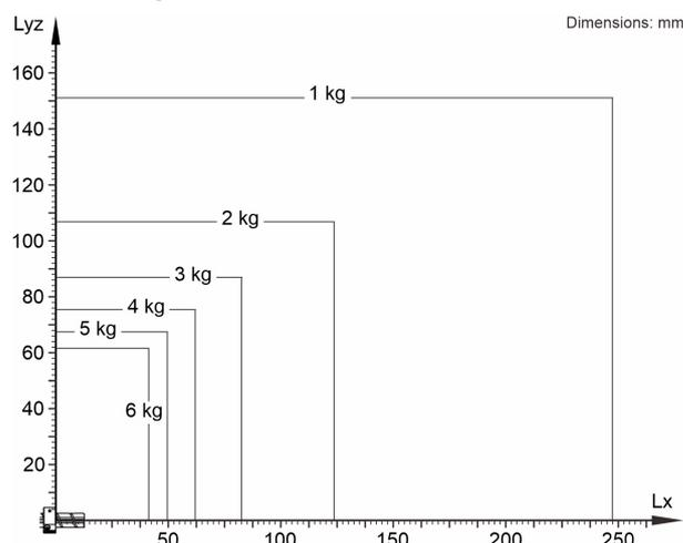
Il KR 6 R700 Z200 è progettato per una portata nominale di 3 kg in grado di sfruttare al meglio le prestazioni e la dinamicità del manipolatore. Con distanze di carico ridotte possono essere utilizzati anche carichi maggiori fino al carico portante massimo. La situazione di carico specifica deve essere verificata con KUKA.Load. Per un'ulteriore consulenza il servizio di assistenza KUKA rimane a vostra disposizione.
