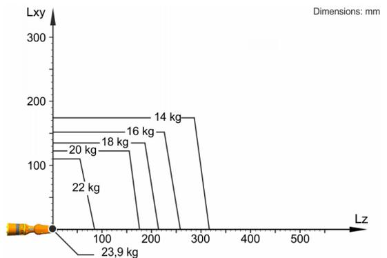
Der KR 20 R1810 F ist ausgelegt für eine Nenn-Traglast von 20 kg, um die Performance und Dynamik des Roboters optimal zu nutzen. Nur wenn die Lage des Massenschwerpunkts 0 mm und eine für den Lastfall optimierte Zusatzlast angebracht sind, gilt die maximale Traglast von 23,9 kg. Der spezifische Lastfall muss mit KUKA.Load oder KUKA Compose überprüft werden. Für weitere Beratung steht der KUKA Support zur Verfügung.
